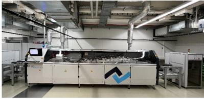
**Bildtext:** Durch die neue THT-Linie verringert sich der Flussmittelverbrauch der Wellenlötanlage um etwa 75 Prozent und gleichzeitig verdoppelt sich die Durchlaufgeschwindigkeit der Löttrahmen auf 140cm/min.
