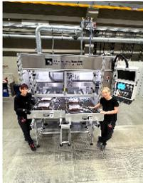
**Bildtext:** Im Telenot-Werk 2 in Essingen sorgt eine neue Bolzenschweißmaschine für höhere Effizienz und Präzision in der Produktion.
