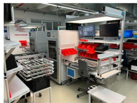
**Bildtext:** Die neuen höhenverstellbaren Bestückungsplätze ermöglichen ein effizienteres und gleichzeitig rückschonendes Arbeiten.
